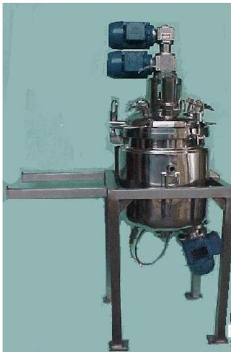
Reator capacidade útil de 25 litros, de movimento duplo, com turbina homogeneizadora de fundo.
