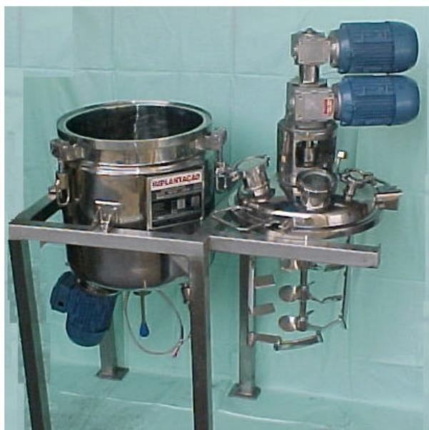
Detalhe do Reator aberto onde pode-se ver o agitador de movimento duplo, com as hélices centrais e a âncora periférica com raspador.
